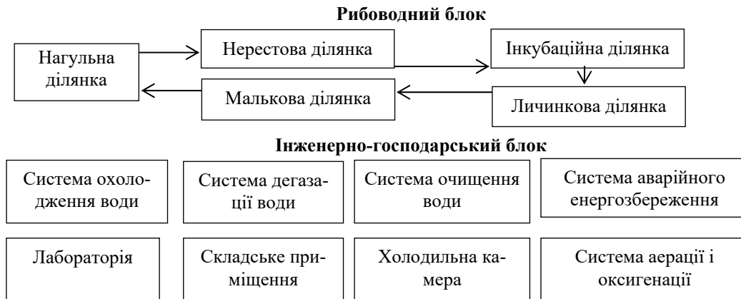
Рис. 1. Принципова схема повносистемного форелевого господарства
